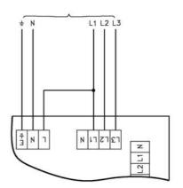
SINGLE PHASE FANS WITH SPEED CONTROLLER TO 220-240V ~ 50Hz SUPPLY
